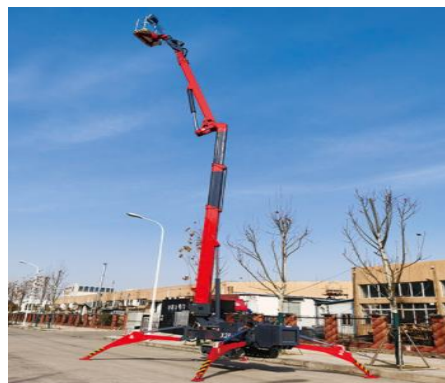
コンパクトで狭い場所にも侵入可能な高所作業車「KX-28」最大高28m
