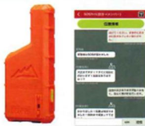
専用アプリで無線接続可能 携帯圏外でも使用できる、 コミュニケーションツール
